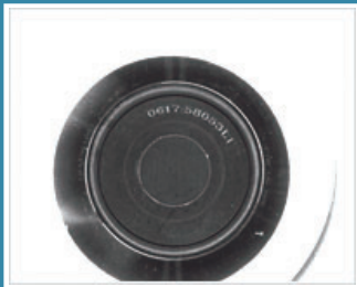
用外同軸檢測光碟的缺陷,表面刮痕成像清晰
