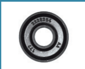
用外同軸檢測金屬零件,表面凸字清晰
