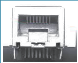
適合接頭 Pin 腳需要做縫隙間距的檢測
