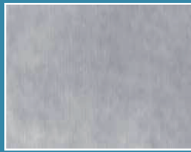
用聚光型線光檢測大面積金屬表面均勻性好
